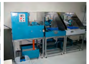
<NX Core 종/횡 방향 절단> <한국기초과학지원연구원 암석절단실>
