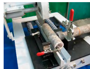
<NX Core 종/횡 방향 절단> <한국기초과학지원연구원 암석절단실>
