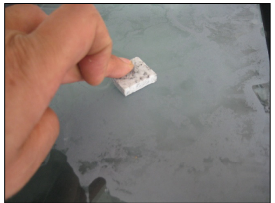
< 암석편 마지막 연마는 실리콘 파우더 1500#로, 박편 수 작업대들 > (일반적인 연마박편에 대한 것임. EPMA 분석 시, Polishing Plate를 사용)
