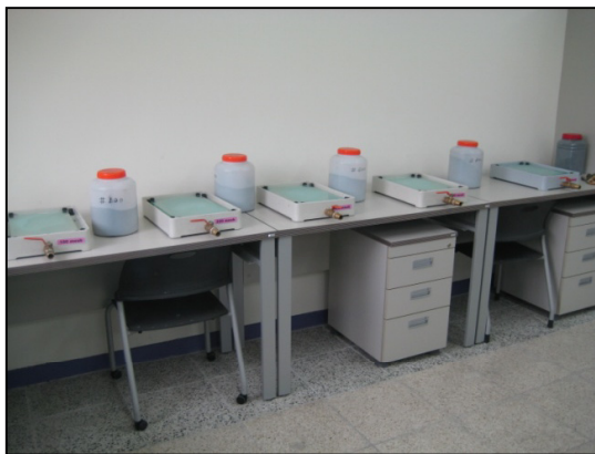
< 암석편 마지막 연마는 실리콘 파우더 1500#로, 박편 수 작업대들 > (일반적인 연마박편에 대한 것임. EPMA 분석 시, Polishing Plate를 사용)
