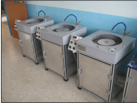
< 단계별(200#, 400#, 800#,1500#) 암석연마기들과 다이아몬드 디스크들 > (앞 단계의 큰 입자들에 의한 오손(긁힘) 방지를 위한 단계별 연마기의 사용)
