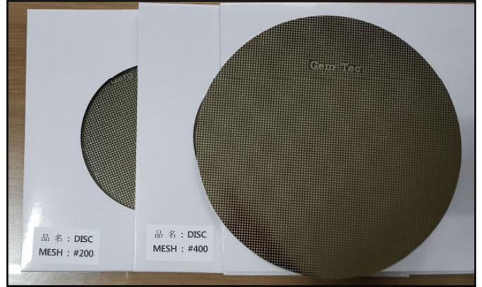
< 단계별(200#, 400#, 800#,1500#) 암석연마기들과 다이아몬드 디스크들 > (앞 단계의 큰 입자들에 의한 오손(긁힘) 방지를 위한 단계별 연마기의 사용)
